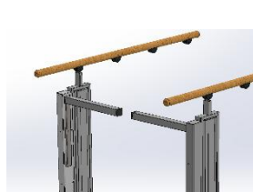
Fig. 2: De automatische platformbarrière (aanvullende voorziening) komt omhoog en wordt vergrendeld
